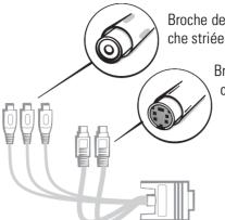
Broche de raccordement vidéo composite au niveau des câbles (broche striée)
