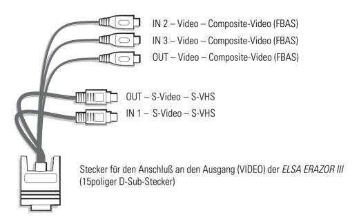
Beim Anschluß eines Gerätes an die Kabelpeitsche ist nur zu überlegen:
