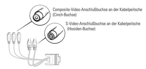
Einige Videorecorder und Fernsehgeräte verfügen nur über eine sogenannte SCART-Buchse. In diesem Fall benötigen Sie für die Verbindung mit der ELSA ERAZOR III einen speziellen Adapter nach S-Video oder Composite. Hier hilft Ihnen der Radio-Fernseh-Fachhandel weiter.
